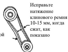
Рисунок 2. Натяжение клинового ремня
